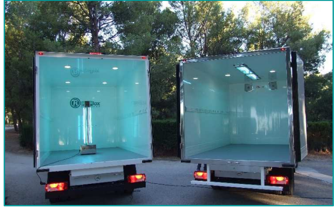
Ilustración 7. Izquierda, sistema móvil, Derecha, sistema fijo.
