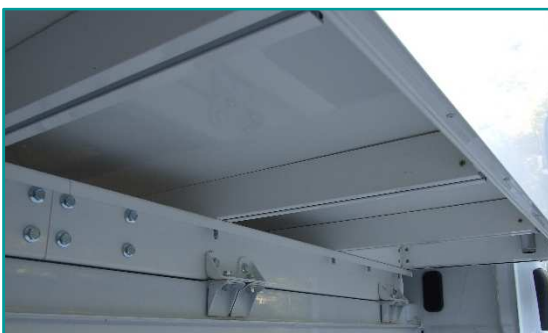
Ilustración 3. Revestimiento exterior piso prensado
